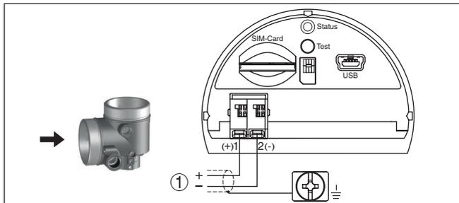
Рис. 30: Отсек подключения (модуль PLICSMOBILE)
