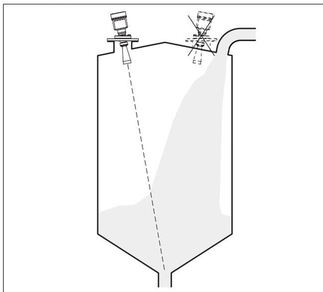
Рис. 7: Монтаж радарного датчика при втекающем продукте
