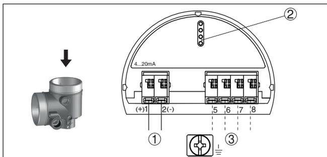
Рис. 31: Отсек электроники (двухкамерный корпус, Ex d ia)
