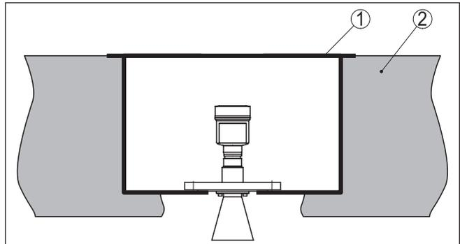
Рис. 20: Монтаж прибора в коробе под полом
