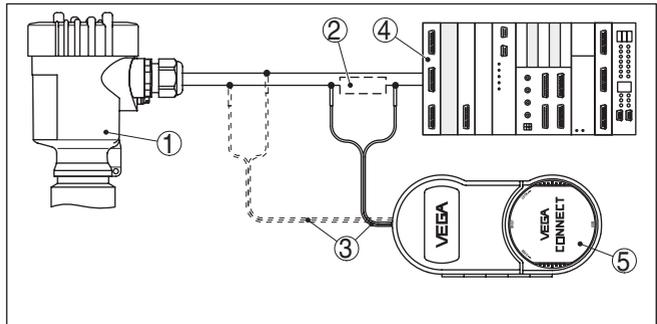
Рис. 42: Подключение ПК к сигнальному кабелю через HART
