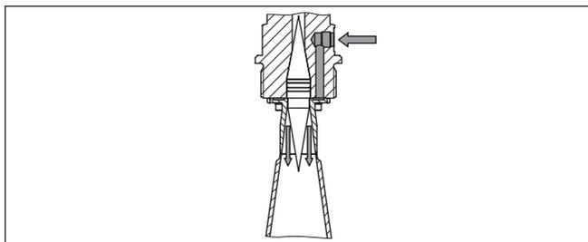
Рис. 23: Вход для подключения продувки рупорной антенны
