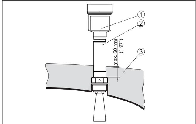
Рис. 19: Монтаж устройства на емкости с термоизоляцией
