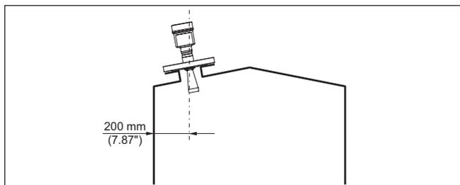
Рис. 6: Монтаж радарного датчика на крыше емкости
