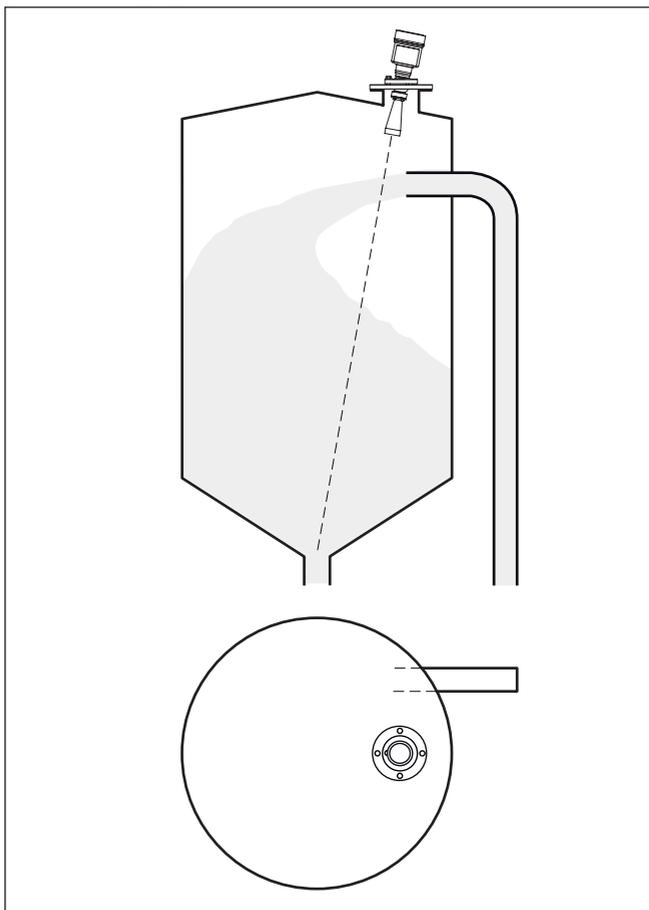
Рис. 8: Монтаж радарного датчика при втекающем продукте
