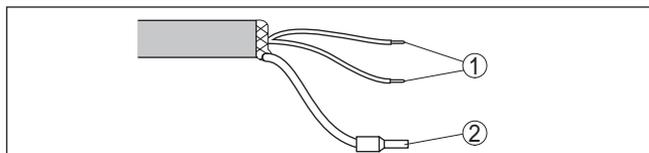
Рис. 36: Назначение проводов постоянно подключенного соединительного кабеля
