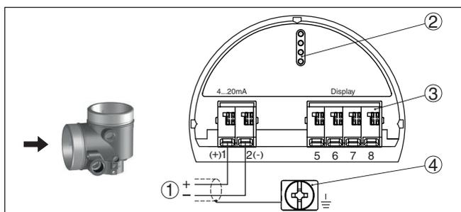
Рис. 29: Отсек подключения (двухкамерный корпус)
