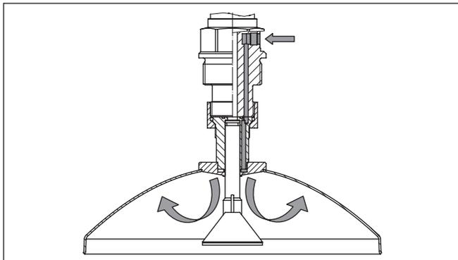
Рис. 24: Вход для подключения продувки параболической антенны
