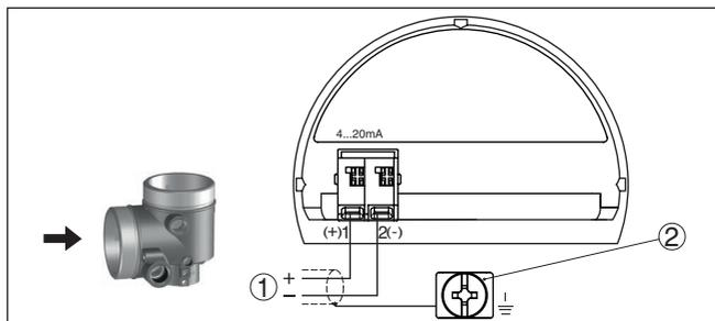
Рис. 32: Отсек подключения (двухкамерный корпус, Ex d ia)
