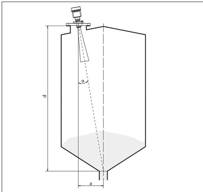
Рис. 15: Рекомендация по монтажу VEGAPULS SR 68 с наклоном
