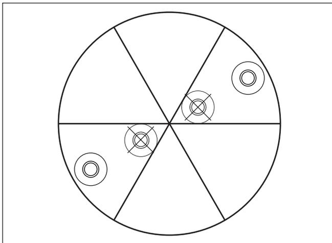
Рис. 21: Монтаж VEGAPULS SR 68 в многокамерном силосе
