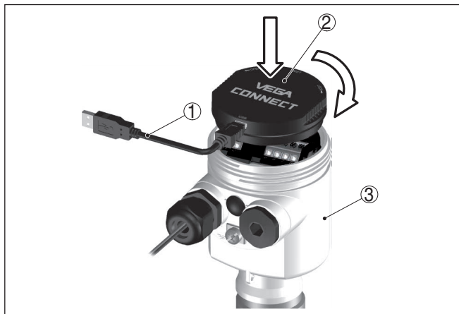
Рис. 38: Подключение ПК через интерфейсный адаптер прямо к датчику
