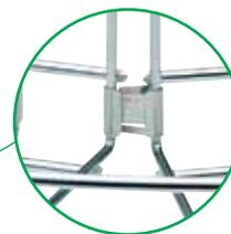
Простое выполнение поворота лотка непосредственно при монтаже: перекусите проволоку в нескольких местах, согните лоток для придания нужной формы и зафиксируйте его с помощью специальных безвинтовых клипс
